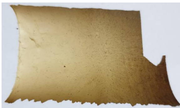
Рисунок 27 – Фотография волокон 9 мас. % ПАН/ДМФ после стабилизации при T_{\text{стаб}} = 260 \text{ } ^\circ\text{C}
