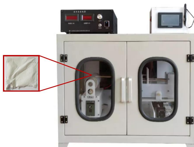
Рисунок 6 – Фотография установки электроспиннинга с барабанным коллектором
