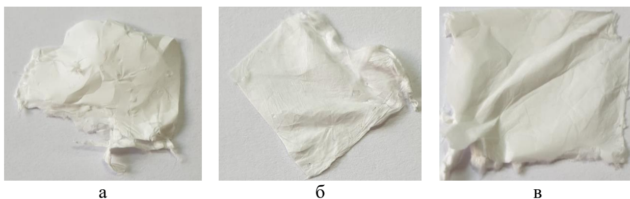
Рисунок 23 – Фотографии волокон, полученных из полимерных растворов, ПАН, различной концентрации: 7 мас. % (а), 9 мас. % (б) и 11 мас. % (в)
