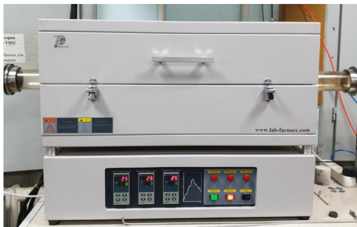
Рисунок 7 – Фотография трубчатой печи с кварцевым реактором для проведения процесса стабилизации и карбонизации
